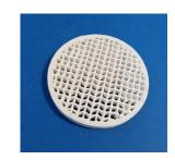
Cette pâte d'alumine prête à l'emploi a été développée pour l'impression 3D par Robocasting, au moyen de systèmes de micro-extrusion à vis.
